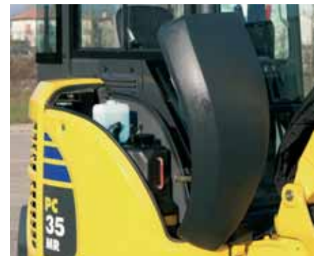
Vordere Wartungsklappe: leichtes Betanken
