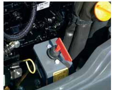
Der Hauptschalter für die Batterie gehört zur Standardausrüstung und befindet sich abschließbar unter der Motorabdeckung.
